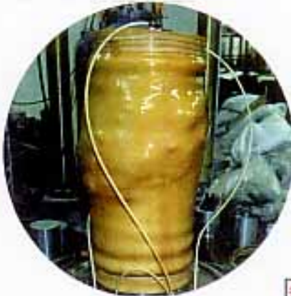
3) 圧縮破壊後の供試体状況
