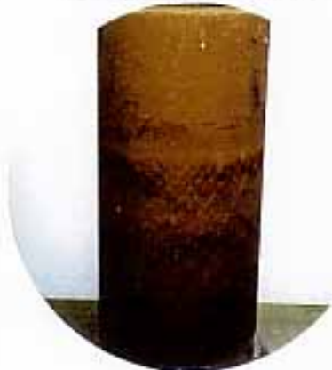
4) ゴムスリーブ着脱後の供試体
