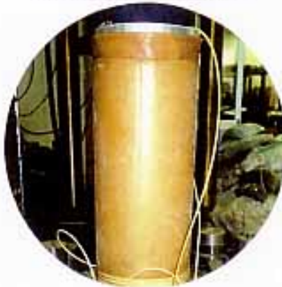
3) 圧縮破壊後の供試体状況
