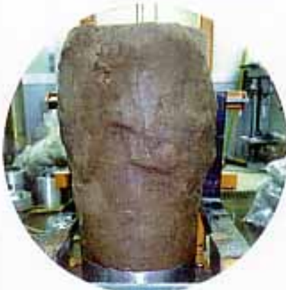
4) ゴムスリーブ着脱後の供試体
